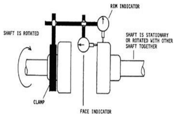
Exemple du comparateur à cadran ou de l'équipement d'alignement laser (Fixturlaser NXA Pro) qui sera utilisé par le concurrent pour exécuter la tâche du projet d'accouplement ou d'alignement d'arbres ci-dessus.
