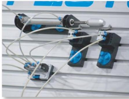
Exemple des composantes Festo Didactic que les concurrents utiliseront pour concevoir, assembler et procéder au diagnostic d'une cascade ou d'un circuit hydraulique séquentiel.
